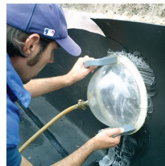
Die Nähte werden zu 100 Prozent mit einer Unterdruck-Saugglocke auf Sicherheit überprüft
