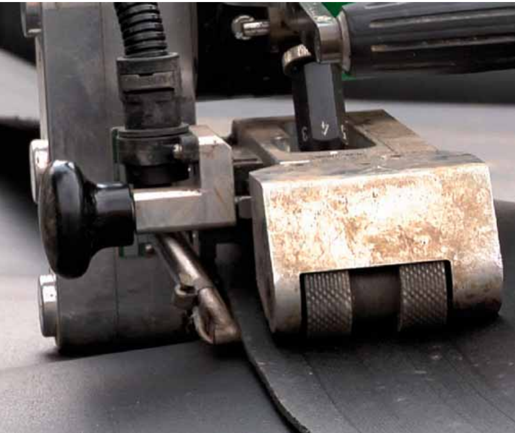
Entscheidend: die thermische Verschweißung.
