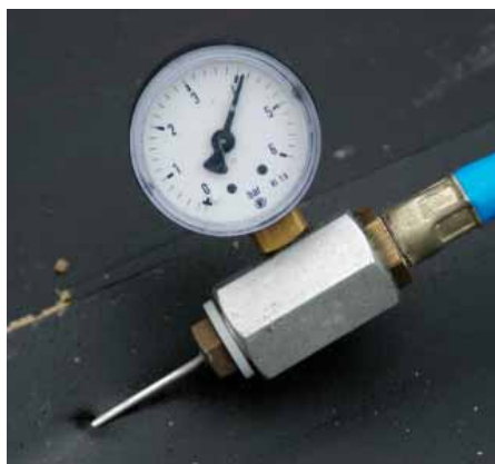
Die Dichtigkeit der Nähte wird per Druckluft-Prüfverfahren gesichert.
